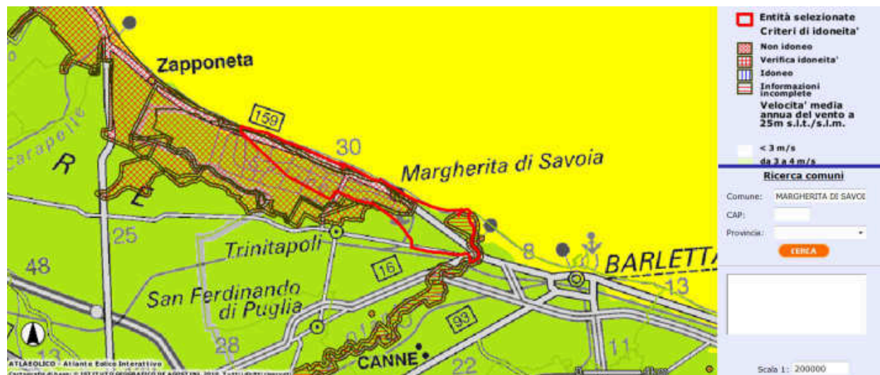
Figura 8: Aree ritenute non idonee per l'installazione degli impianti eolici nel comune di Margherita di Savoia (Fonte: Atlaeolico RSE)
