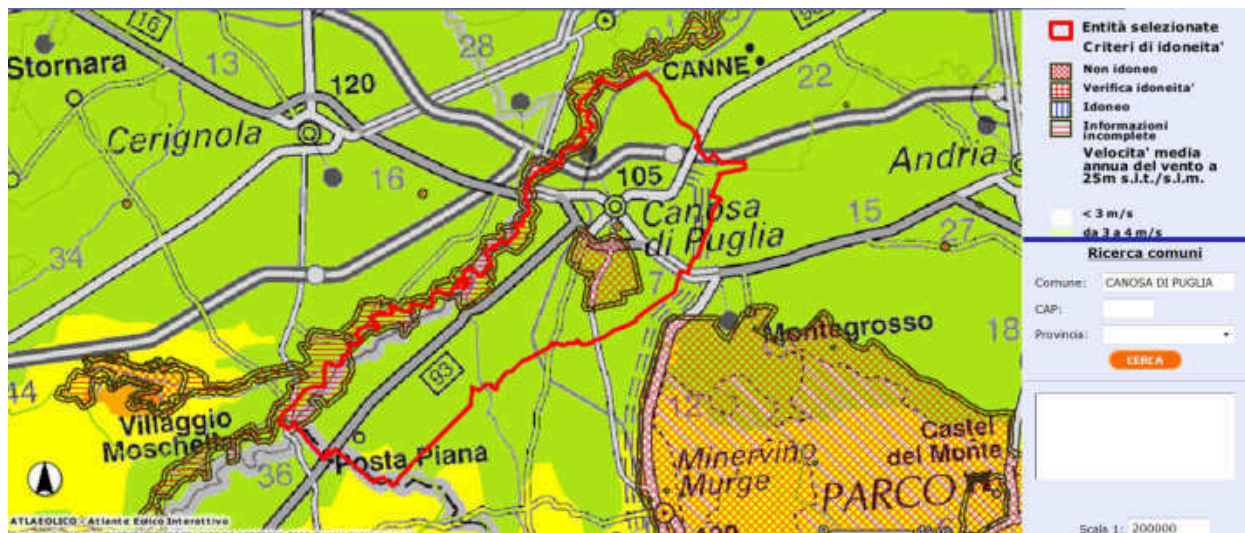
Figura 7: Aree ritenute non idonee per l'installazione degli impianti eolici nel comune di Canosa (Fonte: Atlaeolico RSE)
