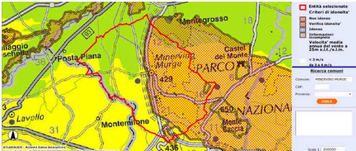
Figura 9: Aree ritenute non idonee per l'installazione degli impianti eolici nel comune di Minervino Murge (Fonte: Atlaelico RSE)
